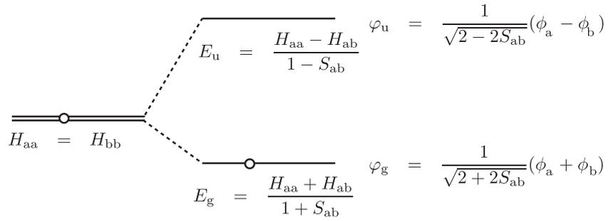
図 5: 水素分子イオンの結合性軌道  $\varphi_g$  と反結合性軌道  $\varphi_u$  のエネルギー準位
