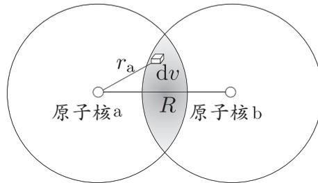
図 2:  $-E_{ab} = - \int (\phi_a \phi_b / r_a) dv$  は  $\phi_a$  と  $\phi_b$  の重なり電荷分布と核 a との Coulomb 相互作用エネルギーと解釈できる。
